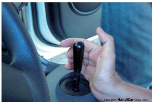
Personen mit schwerer Beeinträchtigung ist es nun auch in Italien offiziell möglich, selbstständig mit einem Joystick ein Fahrzeug zu steuern. Mit diesem Joystick kann das adaptierte Fahrzeug nach vorne und nach hinten bzw. nach rechts und nach links gesteuert werden. Der Fahrer erreicht direkt über eine Rollstuhlrampen mit seinem Rollstuhl den Fahrerplatz. Auf diese Weise ist der Transfer vom Rollstuhl auf den Autositz nicht mehr nötig.
